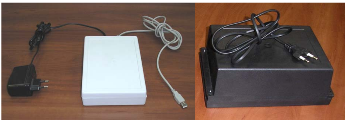
Рис. 3 – микропроцессорный электронный блок и блок питания.
